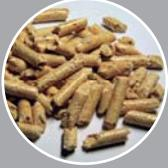
El pellet es un combustible hecho en base a astillas de madera (pino o eucalipto) compactadas por prensado.
