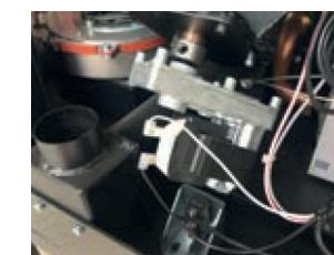
Motoriduttore silenzioso per l'alimentazione del pellet.
