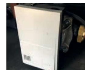
Pompa modulante con prevalenza 6 metri.
